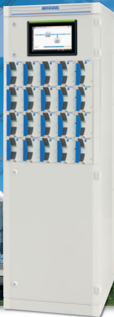
Figuur 3: DC-voedingssysteem van 60 kW, gebaseerd op 4 gelijkrichter rack-units met elk 5 modules van elk 3 kW.
