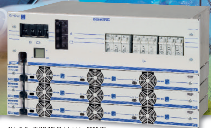
Abb. 5: 9 x SLIMLINE Gleichrichter 2000 SE mit Verteilung 18000 SE DC-Ausgang 48 V / 18000 W
