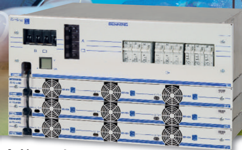
Рис. 5: 9-ти модульный выпрямитель SLIMLINE 2000 SE с распределением 18000 SE Выход ОС 48 В/ 18000 Вт
