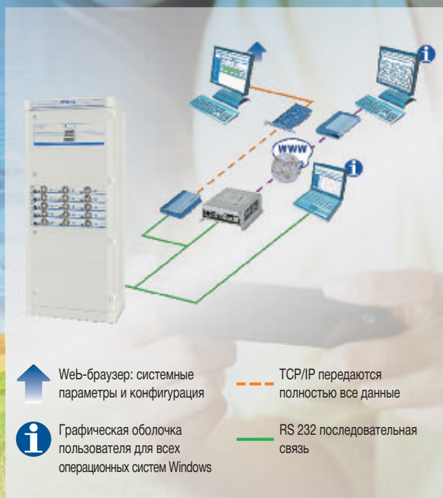
Рис. 9: система удаленного мониторинга MCU 2500
