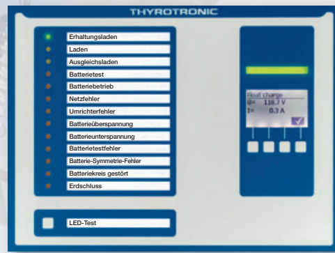
Erweitertes THYROTRONIC Basisdisplay (Abb. 4) Ausstattung mit Anzeige- und Bedieneinheit (LCD und Drucktasten) sowie einer frei konfigurierbaren Statusanzeige
