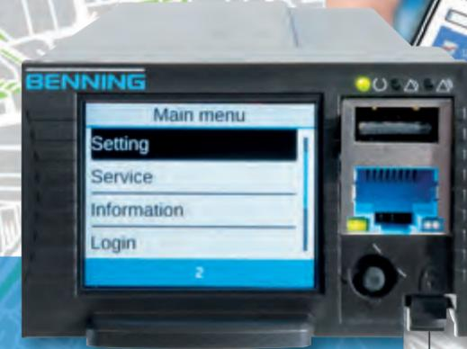
(oben) Der SLIMLINE Controller bietet Fernüberwachung und Betriebssicherheit auf engstem Raum. Dieser wird bei kleinen Leistungen i.d.R. als Modul in den SLIMLINE Carrier eingeschoben. Die Kontrolle über ein mobiles Endgerät ist ebenso möglich. Hier zeigt sich das exzellente Interface-Design der MCU 3000. Es ist intuitiv, objektorientiert und auf das Wesentliche reduziert
