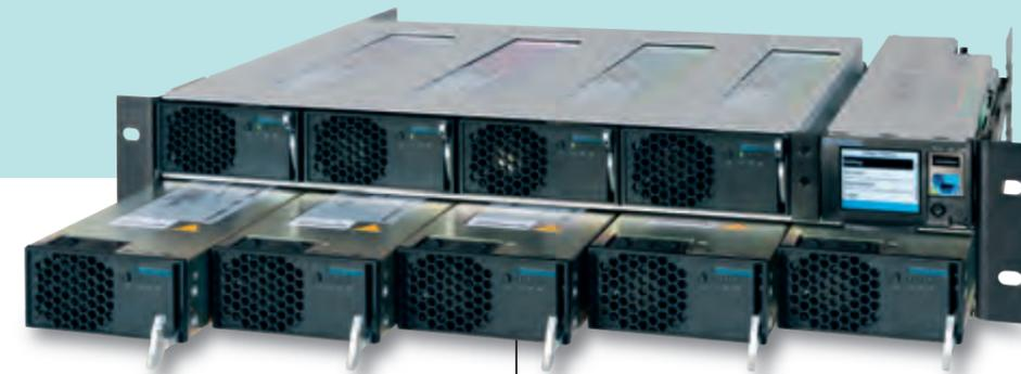
Der 19" 1HE SLIMLINE Carrier kann entweder vier Gleichrichtermodule à 48 V und 3000 W kombiniert mit einem SLIMLINE Controller aufnehmen oder fünf Gleichrichtermodule mit einer Leistung von jeweils 3000 W
