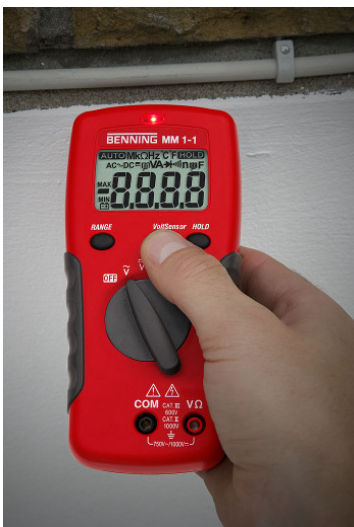
BENNING MM 1-1, Lokalisierung der Phasenspannung an einer NYM-Leitung
