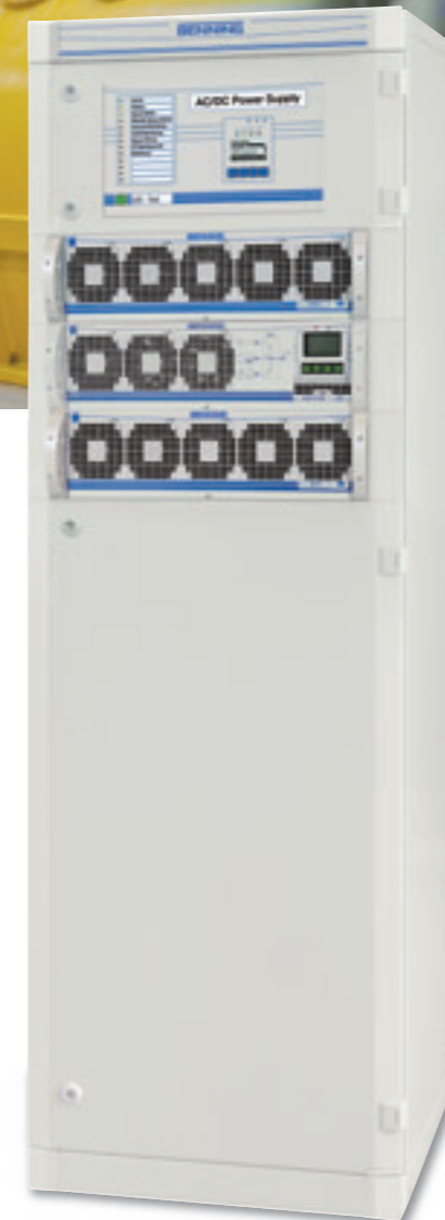
Armoire système – redresseur – onduleur – convertisseur DC Sortie AC 230 V - 4,5 kVA, Sorties DC 220 V - 50 A et 26 V - 250 A
