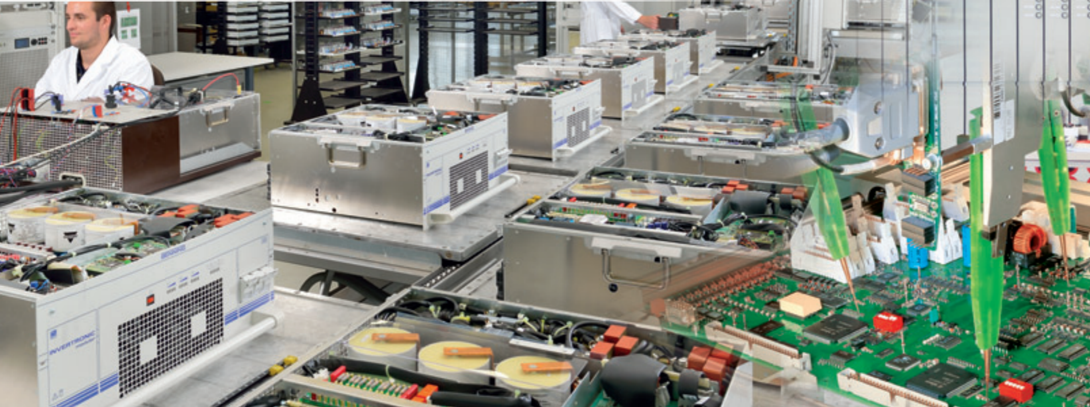
Montage d'onduleurs et banc d'essai Inverter module assembly and test facility
