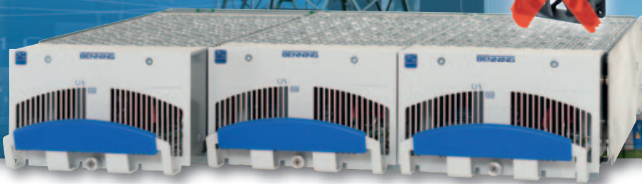
Рис. 2: 19-дюймова корзина з трьома модулями ТЕВЕСНОР 3000 SE з конвекційним охолодженням, вихідною потужністю кожного модуля 1500 Вт.
