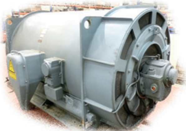
Moteur antidéflagrant après travaux
