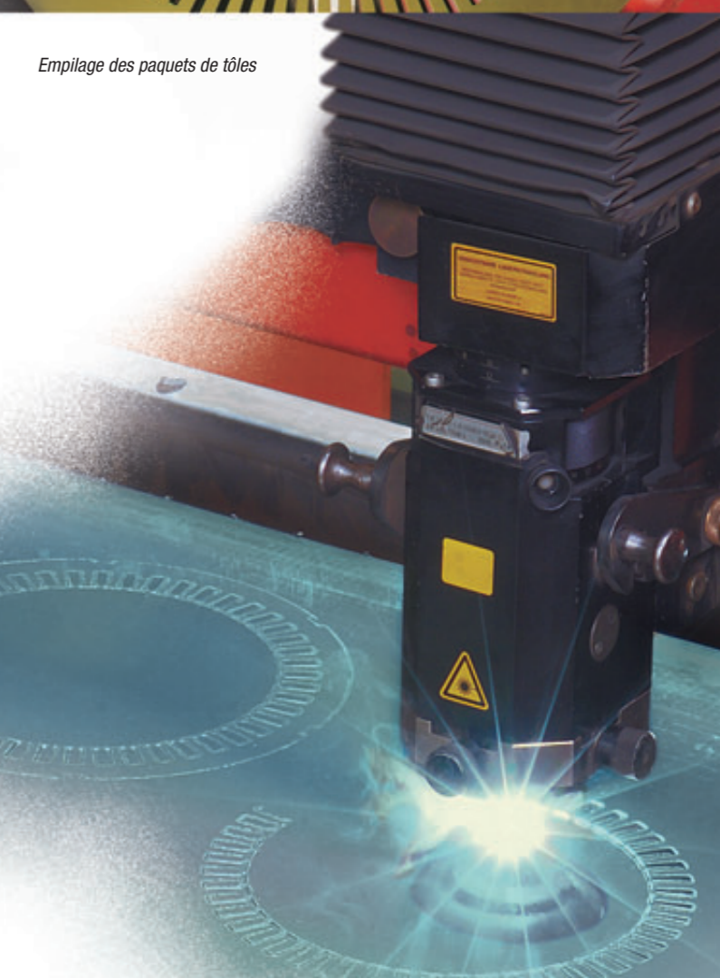
Découpe laser des paquets de tôles
