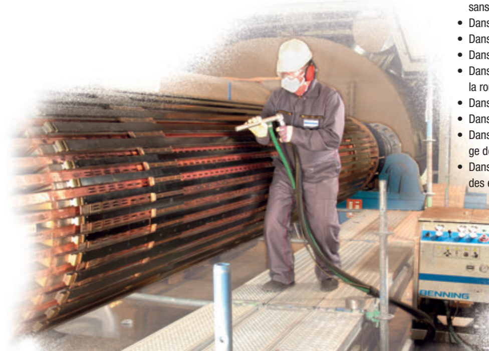
Nettoyage à sec d'un inducteur sur site
