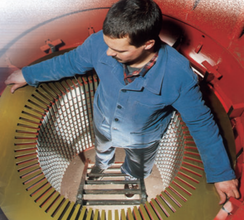
Empilage des paquets de tôles
