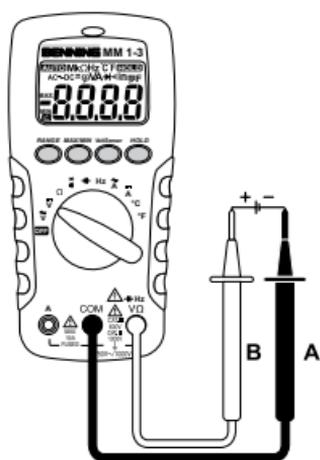
Bild 2: Gleichspannungsmessung
