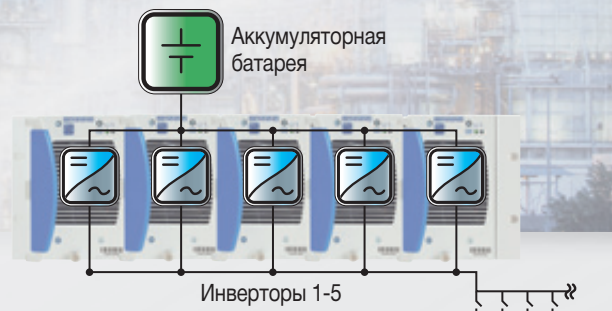
Рис.3: Корзина с 5 инверторными модулями (без переключателя электронного байпаса)
