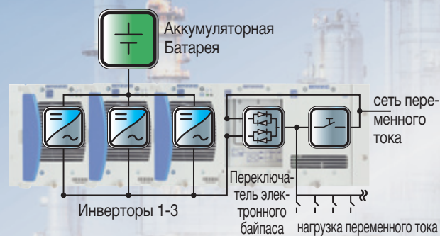
Рис. 2 (сверху): Корзина с 3 инверторными модулями, электронным байпасом и ручным байпасом
