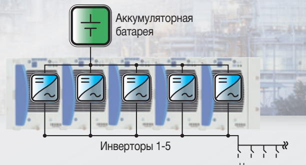
Рис.3: Корзина с 5 инверторными модулями (без переключателя электронного байпаса)
