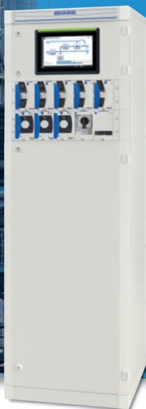
Armoire système redresseur / onduleur (Fig. 1) Ce système est équipé de 3 modules onduleurs, de modules de commutation de bypass électronique "EUE" et de bypass manuel, d'une puissance de sortie de 4,5 kVA et de 5 modules redresseurs, d'une tension de sortie de 220 V DC et d'une puissance de sortie de 50 A DC.
