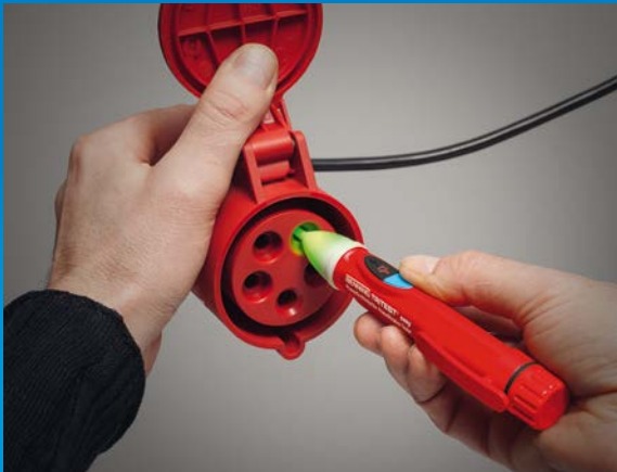
Testen van de fasevolgorde op de CEE-koppeling met TRITEST® easy
