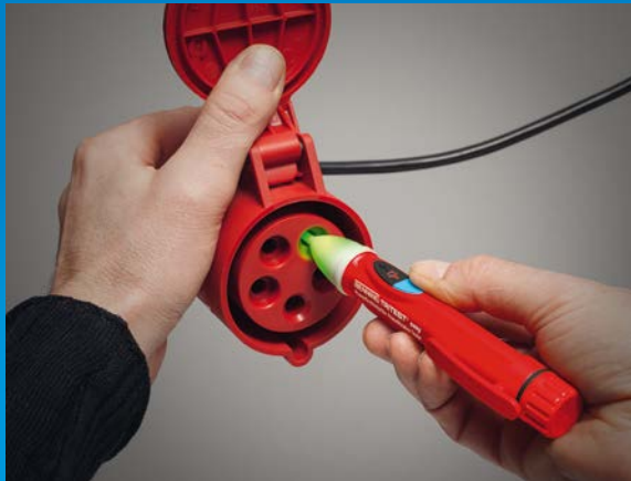
Tests d'ordre de phases aux coupleurs CEE avec l'appareil TRITEST® easy
