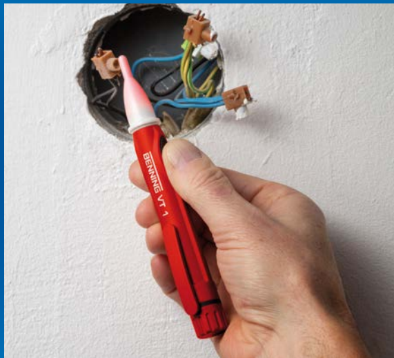
Test de phase aux boîtes de distribution avec l'appareil BENNING VT 1
