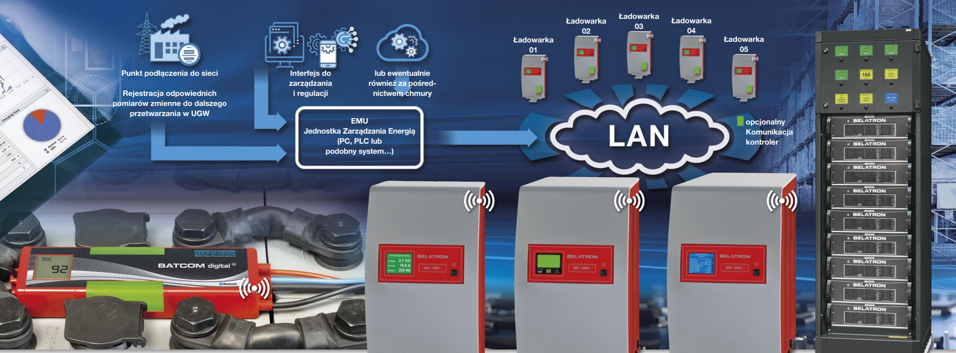
Rys. 5: Dzięki kontrolerowi akumulatorów BATCOM digital+ rejestrowanie i zapisywanie odpowiednich danych operacyjnych w interakcji między wózkami, akumulatorami i ładowarkami jest proste. Dane można gromadzić w dowolnym momencie za pośrednictwem łącza Bluetooth®
