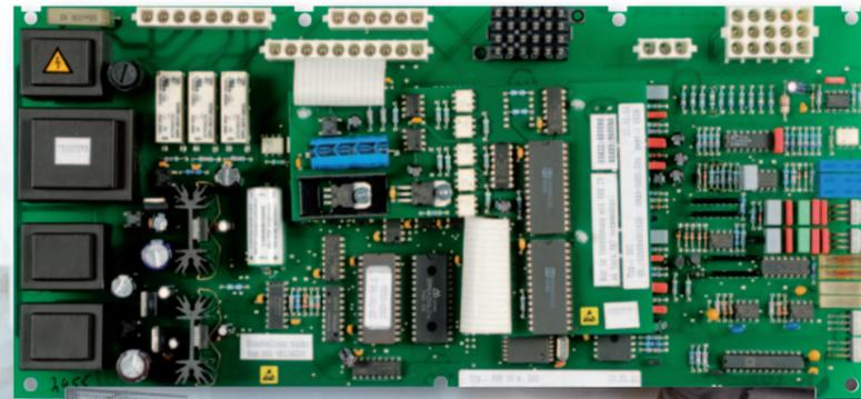
Abb. 4 (oben): Programmierbare Steuereinheit PSE
