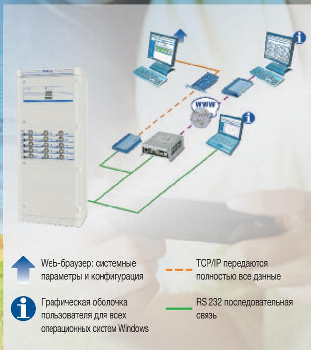
Рис. 9: система удаленного мониторинга MCU 2500
