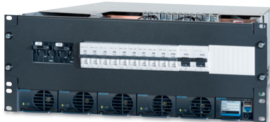
Abb. 6: SLIMLINE System 48 V / 10 kW mit SLIMLINE Controller sowie Batterie- und Verbraucherverteilung. Durch Skalierung der Gleichrichter und Anpassung der DC-Verteilung können Leistungen von 2 – 34 kW realisiert werden.
