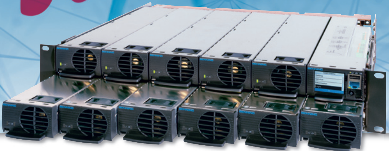
Abb. 3: Der 19" 1HE SLIMLINE Carrier kann entweder fünf Gleichrichtermodule à 48 V und 2 000 W kombiniert mit einem SLIMLINE Controller aufnehmen oder sechs Gleichrichtermodule
