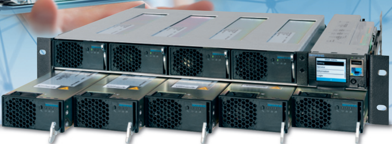
Abb. 3: Der 19" 1HE SLIMLINE Carrier kann entweder vier Gleichrichtermodule à 48 V und 3000 W kombiniert mit einem SLIMLINE Controller aufnehmen oder fünf Gleichrichtermodule
