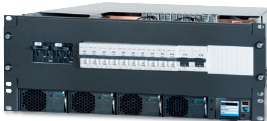
Abb. 6: SLIMLINE System 48 V / 12 kW mit Controller sowie Batterie- und Verbraucherverteilung. Durch Skalierung der Gleichrichter und Anpassung der DC-Verteilung können Leistungen von 3 – 27 kW realisiert werden.
