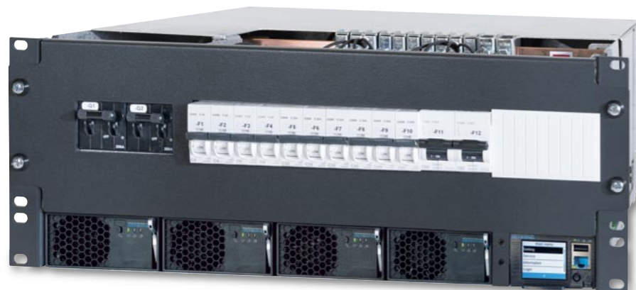
Рис. 6: Система SLIMLINE 48 В / 12 кВт с контроллером, а также батарей и распределительной панелью подключения потребителей. Номинальная мощность от 3 до 27 кВт может быть достигнута путем установки необходимого количества выпрямительных модулей и панели распределения.
