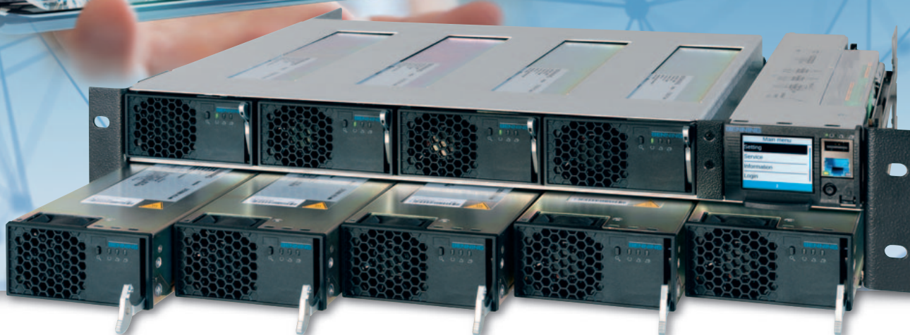
Obr. 3: 19 palcový 1U nosič pojme buď čtyři 48 V / 3000 W usměrňovačové moduly v kombinaci s MCU nebo pět usměrňovačových modulů.
