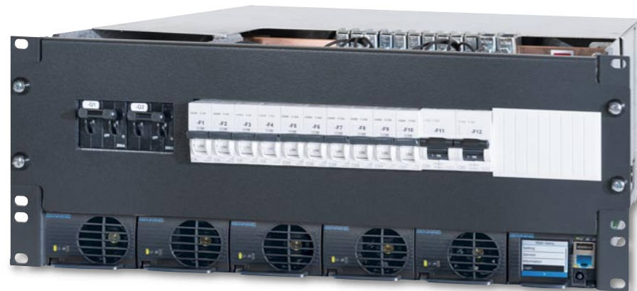
Obr. 6: Systém SLIMLINE 48 V / 10 kW s modulem řídicí a monitorovací jednotky a distribuci pro baterie a spotřebiče. Výkonu 2 – 34 kW lze dosáhnout díky rozšiřitelnosti usměrňovačů a přizpůsobitelnosti distribučního pole.
