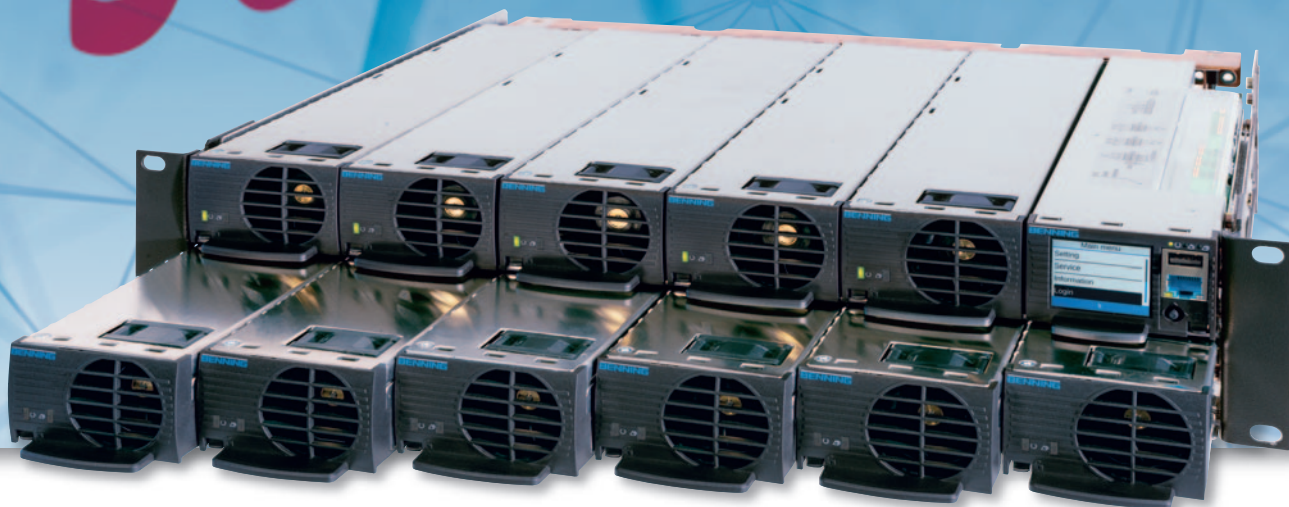
Fig. 3: Il carrier da 19" 1 U può ospitare fino a cinque moduli raddrizzatori da 48 V / 2000 W più un modulo di controllo, oppure fino a sei moduli raddrizzatori di pari potenza.
