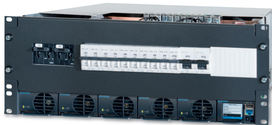
Fig. 6: Sistema SLIMLINE 48 V / 10 kW con modulo di controllo, connessioni alla batteria e ai carichi. La potenza installata è scalabile da 2 a 34 kW mediante l'aggiunta di moduli e la rimodulazione della sezione di distribuzione.
