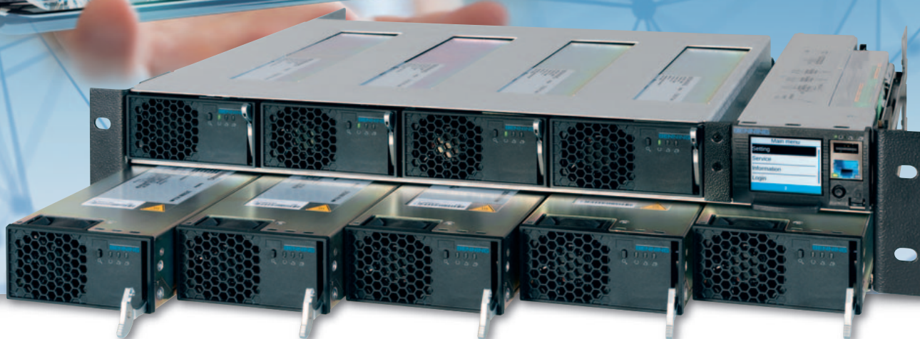
Fig. 3: Il carrier da 19" 1U può ospitare fino a quattro moduli raddrizzatori da 48 V / 3000 W più un modulo di controllo, oppure fino a cinque moduli raddrizzatori di pari potenza.
