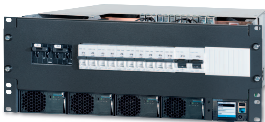
Fig. 6: Sistema SLIMLINE 48 V / 12 kW con modulo di controllo, connessioni alla batteria e ai carichi. La potenza installata è scalabile da 3 a 27 kW mediante l'aggiunta di moduli e la rimodulazione della sezione di distribuzione.
