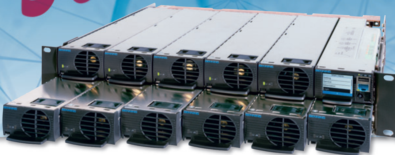
Slika 3: 19" 1H nosač može primiti ili pet ispravljačkih modula od 48 V i 2000 W u kombinaciji s kontrolerom ili šest ispravljačkih modula.
