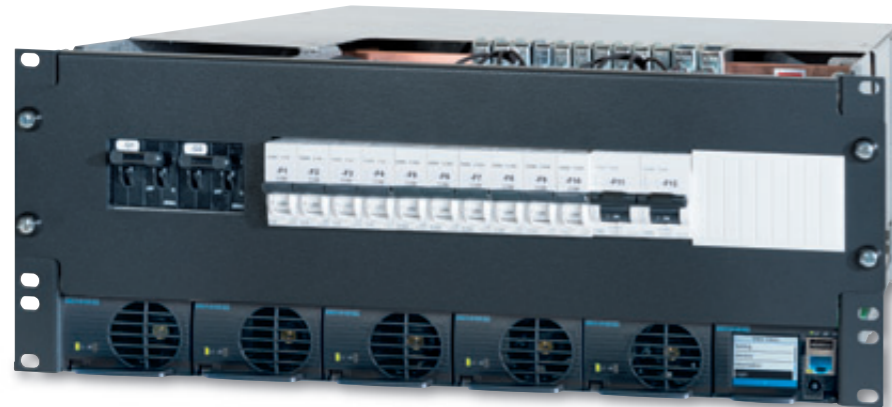
Slika 6: SLIMLINE sustav 48 V / 10 kW sa SLIMLINE kontrolerom, kao i distribucijom baterije i potrošača. Snage od 2 – 34 kW mogu se postići skaliranjem ispravljača i prilagodbom distribucije.
