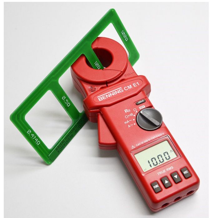
Turnusgemäße Überprüfung der Messgenauigkeit mittels der mitgelieferten Referenzwiderstandschleife.
