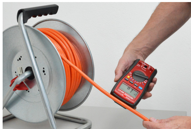
Leidingsonderbreking op een kabelhaspel vinden
