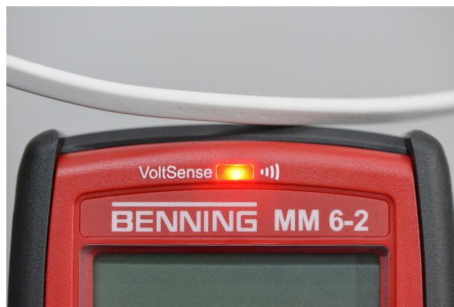
Detectie van spanningsgeleidende leidingen
