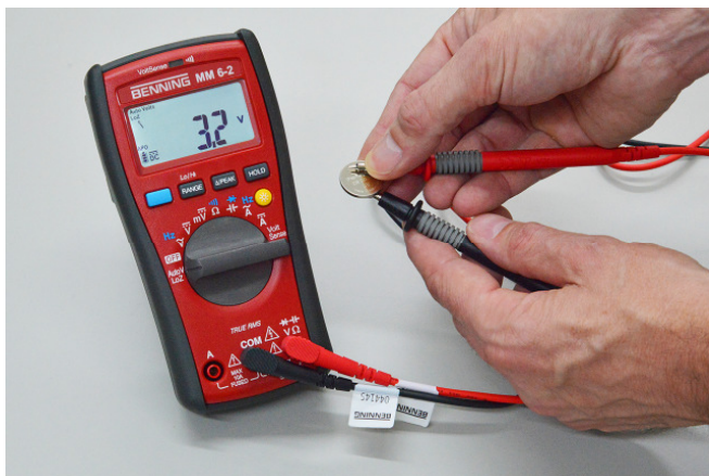
LoZ-spanningsmeting op een reservebatterij
