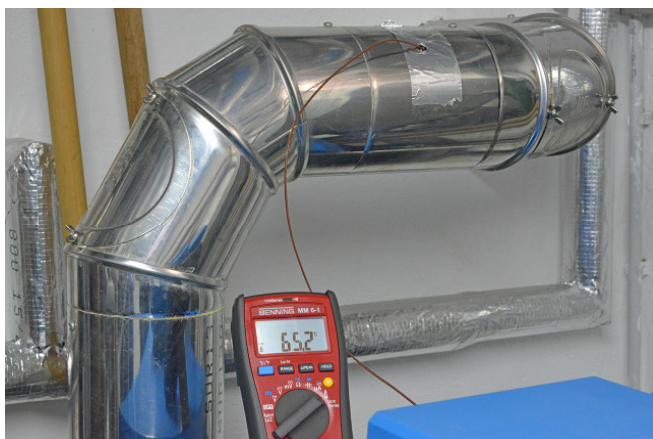
Meting van de uitlaatgastemperatuur
