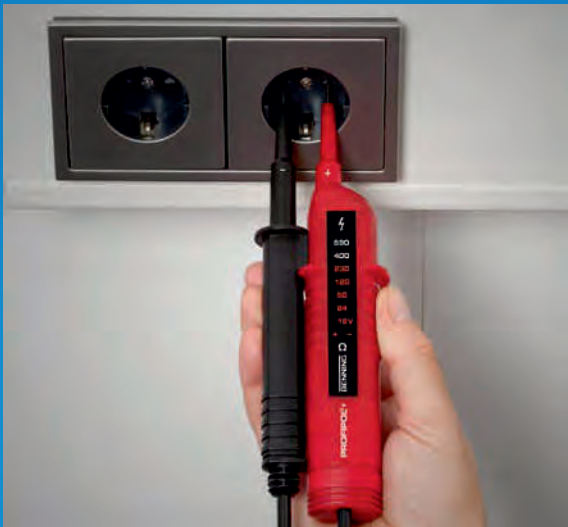
Измерение напряжения одной рукой для розеток
