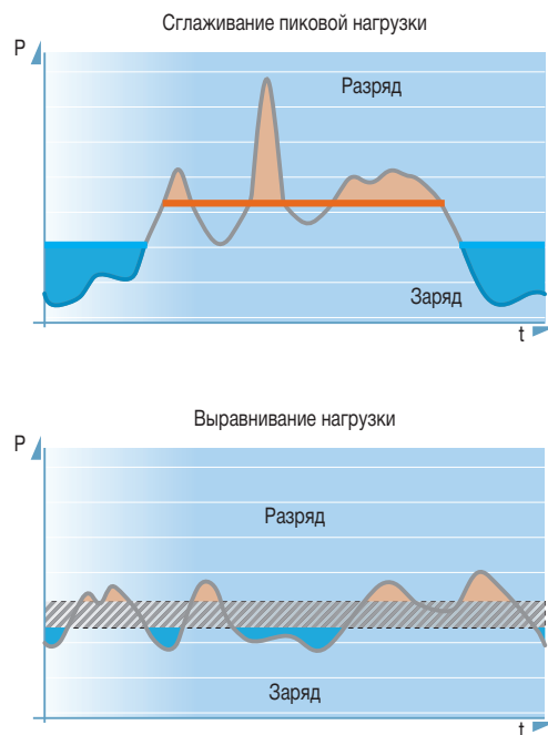
Рис. 5: ИБП ENERTRONIC modular Storage обеспечивает функции регулирования, такие как выравнивание нагрузки и сглаживание пиковой нагрузки
