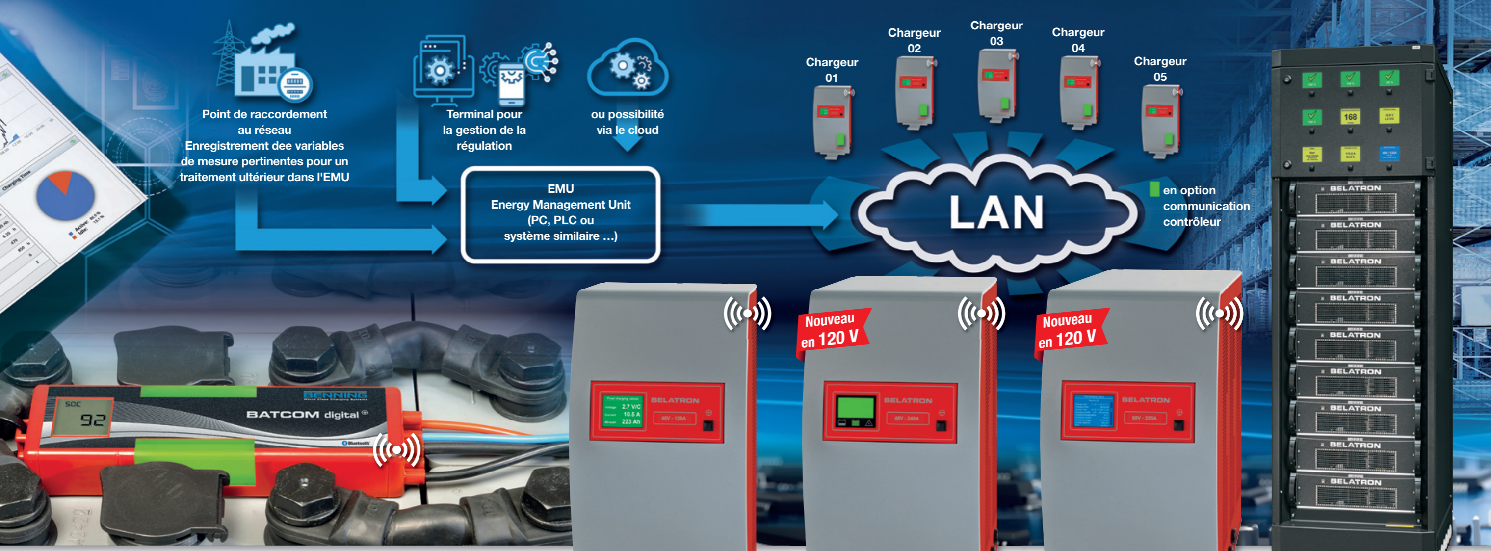
Fig. 5: Avec le contrôleur de batterie BATCOM digital+, il est facile de configurer et de sauvegarder les données de fonctionnement pertinentes dans l'interaction entre les engins de maintenance au sol, les batteries de traction et les chargeurs: les données peuvent être collectées à tout moment via la liaison Bluetooth®
