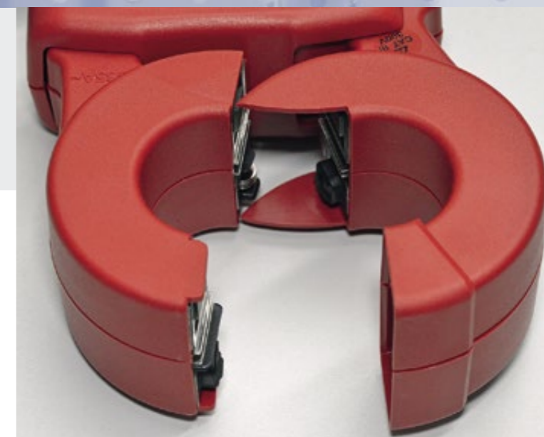
Messkopf der BENNING CM E1 mit zwei getrennten Messspulen und einer großen Zangenöffnung von 38 mm.
