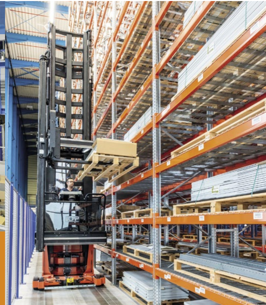
Schmalganglager für Spezialpaletten mit einer Absetzhöhe bis 16,50 m
