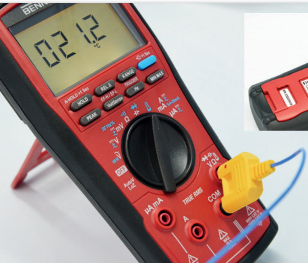
Temperaturmessung mittels mitgeliefertem Thermodracht vom Typ K mit 0,1 °C Auflösung, Tischaufsteller ausgeklappt
