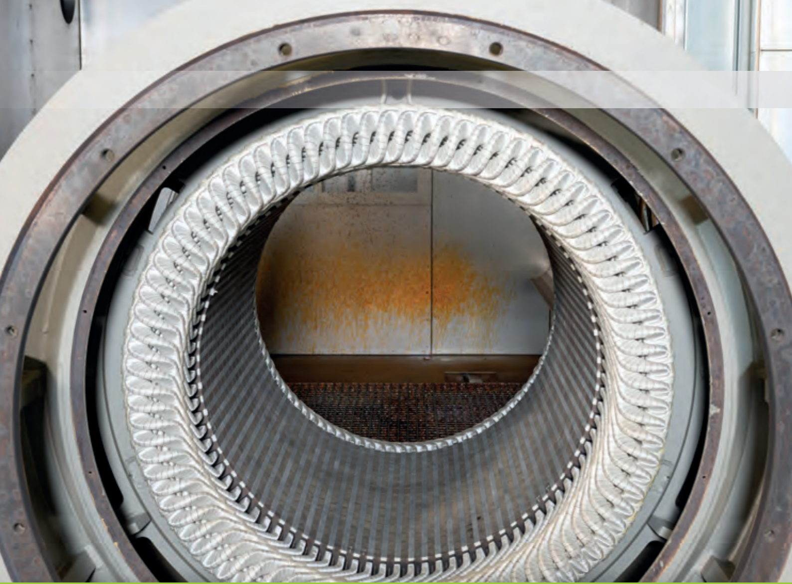
Gleichstromläufer nach dem Tränken und Trocknen
