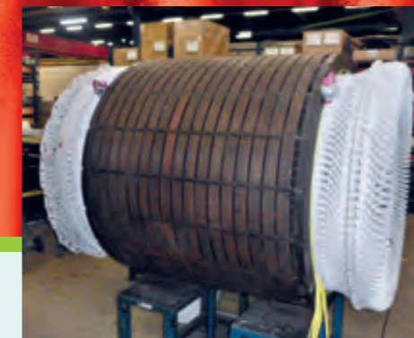
Neu gewickelter Stator vor der Tränkung
