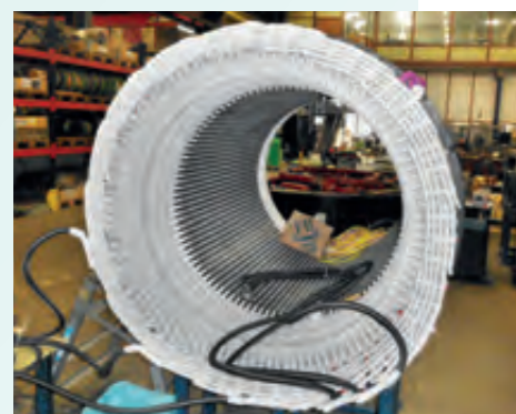
Neu gewickelter Motor (oben) nach und (unten) vor der Tränkung
