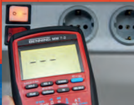
(rechts) Berührungslose Spannungsdetektion. Hiermit können auch Leitungsunterbrechungen, beispielsweise an Verlängerungsleitungen, auf einfache Weise aufgespürt werden
