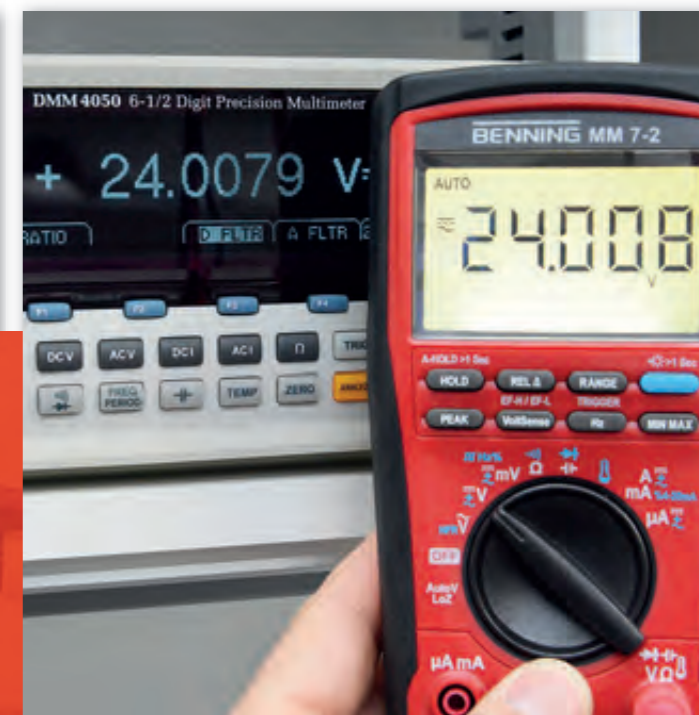
0,03 % DC-Grundgenauigkeit für präzise Messungen und anspruchsvolle Messaufgaben (Vergleichsmessung im Labor mit einem kalibrierten Präzisions-Labormultimeter)
