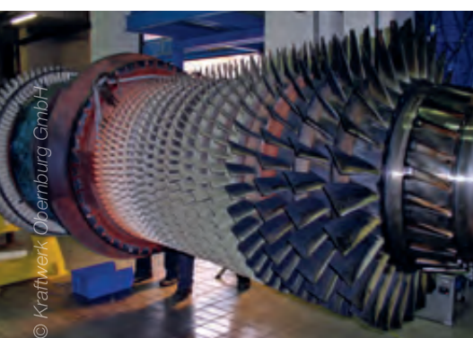
Kontrolle und Revisionsarbeiten an einer Turbine
