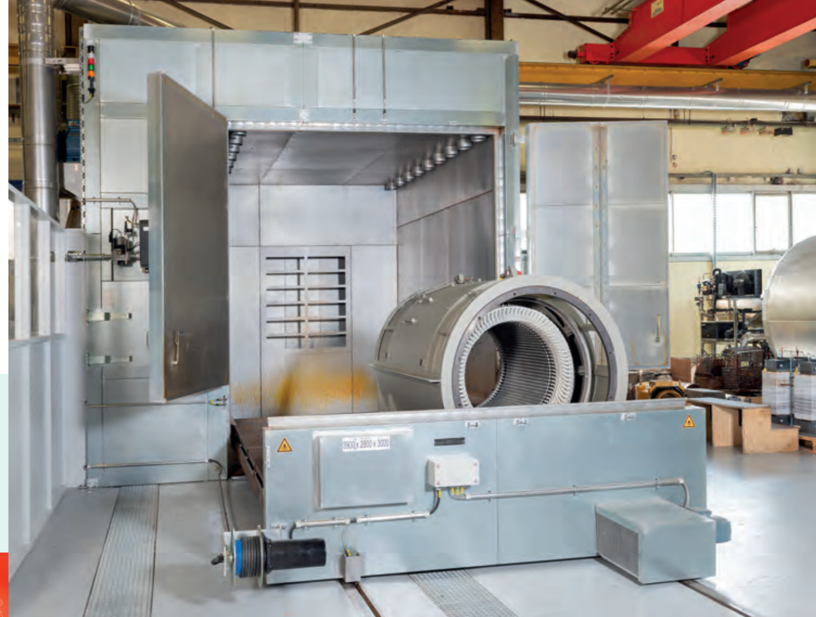
Ein fertiges Bauteil wird aus dem Trockenofen gefahren
