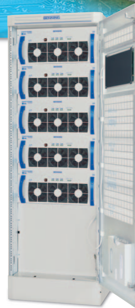
ENERTRONIC modular SE с модулями 20кВА. Выходная мощность 80кВА (n+1)
