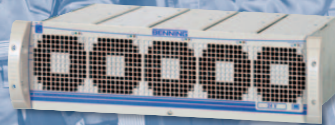
Вставляемый блок конвертера постоянного тока с 5 модулями TEBECHOР 3000 IDC. Выходное напряжение 24В, выходной ток 250А
